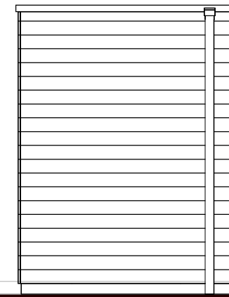
Zijgevel (1:50) tuinzijde prefab berging - enkel type 1
